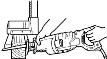
Г) Удобно взяться рукой за рукоятку пилы сабельной. Указательный палец должен находиться на выключателе ВКЛ/ВыКЛ (4). Второй рукой возьмитесь за корпус пилы в области фиксатора пильного полотна, как изображено на рисунке выше.
