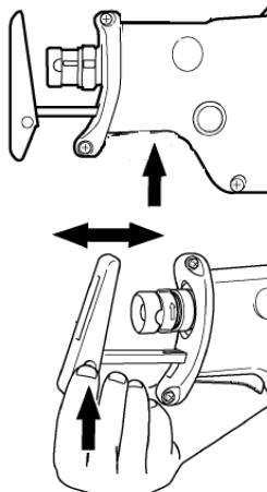
Башмак фиксируется двумя винтами, расположенными на нижней части пилы в области держателя пильного полотна. Для их отвинчивания необходимо использовать шестигранный ключ (7).
