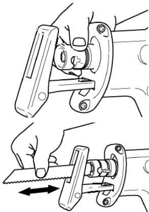
Поверните фиксатор держателя пильного полотна (3) до конца по часовой стрелке. Вставьте ножовочное полотно (1) в держатель как можно дальше. Фиксатор держателя полотна повернётся, и ножовочное полотно зафиксируется. Установка пильного полотна производится режущей частью вниз.
