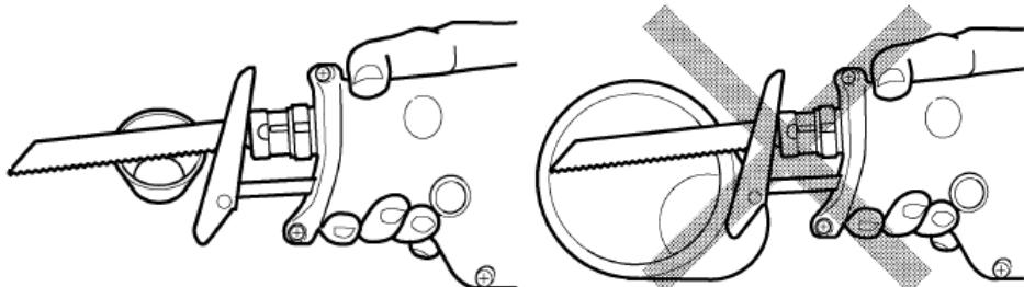
При резке деревянных заготовок больших размеров важно чтобы пильное полотно не ударялось об внутреннюю часть, как показано на рисунке ниже.
