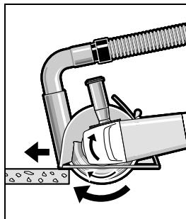
Включите электроинструмент и установите его передней частью направляющих салазок на деталь. Перемещайте электроинструмент с умеренной, соответствующей обрабатываемому материалу подачей.
