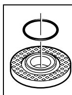
**Посадочный фланец для шпинделя M 14:** В
