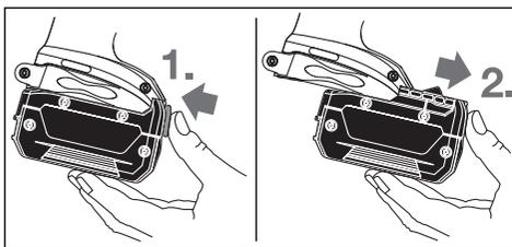
Чтобы извлечь аккумуляторную батарею (6), нажмите на кнопку разблокировки (7) и извлеките аккумуляторную батарею из электроинструмента, потянув ее назад. **Не применяйте при этом силы.**
