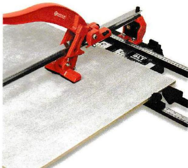
**2. Разрезание.** Одной рукой держите плитку, а другой рукой поднимите ручку и проведите от начала до конца плитки, убедившись, что рез будет проходить точно по линии разметки. Затем нажмите на ручку и с нажимом проведите роликом по плитке. Если давление слишком большое, то оно может уменьшить ресурс работы ролика. Если давление маленькое, то линия реза будет неравномерная и плитка может сломаться неправильно.
