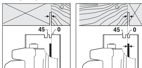
Метка угла пропила **0° 9** показывает положение пильного диска при распиле под прямым углом. Метка угла пропила **45° 8** показывает положение пильного диска при распиле под углом **45°**.
