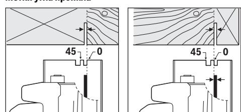
Метка угла пропила **0° 8** показывает положение пильного диска при распиле под прямым углом. Метка угла пропила **45° 7** показывает положение пильного диска при распиле под углом **45°**.
